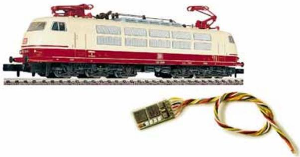
Abb. 5. Lok mit Decoder
